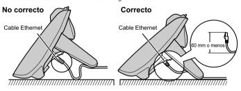
Utilice un cable Ethernet directo CAT 5e (o superior) (no incluido) de un diámetro de 6,5 mm o menos.
