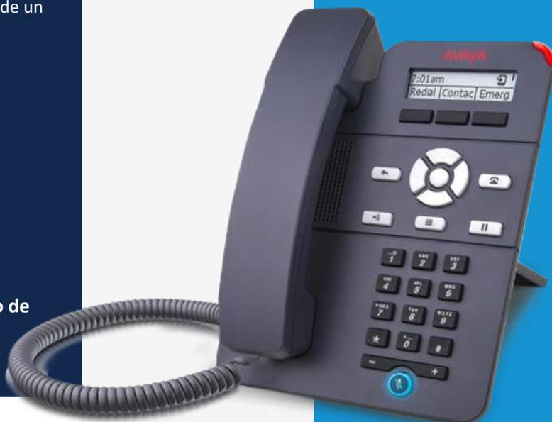
El altavoz full dúplex permite conversaciones con manos libres. Los puertos duales Ethernet 10/100 permiten un cableado más sencillo, ya que una PC ubicada en el mismo lugar obtiene acceso a la LAN a través del teléfono IP J129. El J129 admite Power Over Ethernet PoE como un dispositivo de Clase 1 de bajo consumo, lo que nuevamente elimina el cableado y también permite que los teléfonos funcionen durante cortes de energía si el armario de cableado está respaldado por un sistema UPS.
