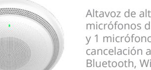
Altavoz de alta fidelidad de 15 W, 3 micrófonos direccionales beamforming y 1 micrófono omnidireccional, cancelación avanzada de eco acústico, Bluetooth, Wi-Fi de doble banda, 1 puerto de 10/100 Mbps, PoE/PoE+, entrada multipropósito de 2 pines, soporte de códec de banda completa y banda ancha
